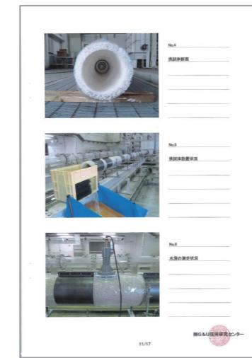
有孔鋼管荷重(圧縮・偏平)試験
